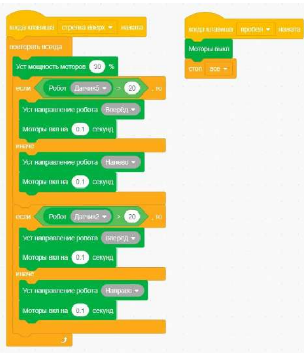
Рисунок 4. – Программа движения по линии на двух датчиках
